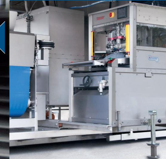
Nachdem ein Bag in die Arretierung eingelegt und der Zapfhahn entfernt wurde, wird die Abfüllstation über die Öffnung des Bags geschwenkt und der Startknopf gedrückt. Die voreingestellte Menge wird mit einer Füllpumpe in den Bag gedrückt.
