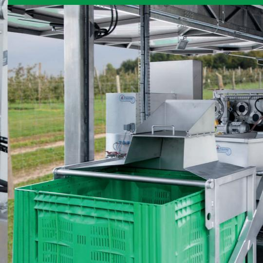
Der Kipper ist komplett aus Edelstahl gefertigt und durch einfache Bedienung mittels Fußtaste lässt sich die Großkiste leicht steuern. Ihre angelieferten Kisten können somit schonend und dosiert in die Waschanlage entleert werden.
